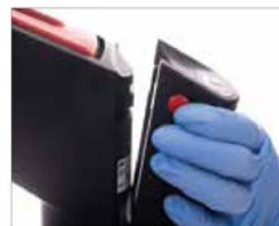
► Нажав обе кнопки разблокировки, аккумулятор можно быстро и легко снять и заменить. Заданные параметры работы сохраняются в течение 30 секунд без питания.
